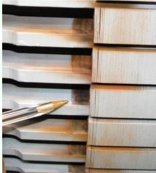
شکل ۱- نمونه‌ای از شل‌شدگی و سایش در ناحیه انتهایی هسته روتور
